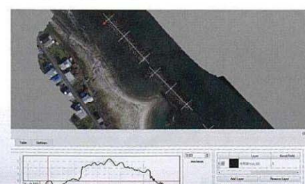
点群データによる離岸堤横断面図
