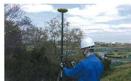
基準点測量(GNSS)
